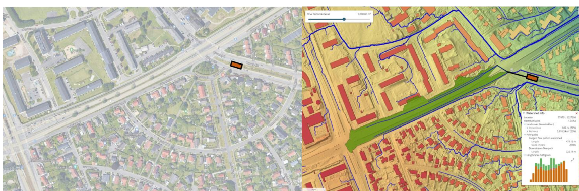
Figur 2.1. Oversigt over område, opland (grønt fremhævet t.h. fra SCALGO Live) og placering af Rockflow (sort omrisset rektangel)
